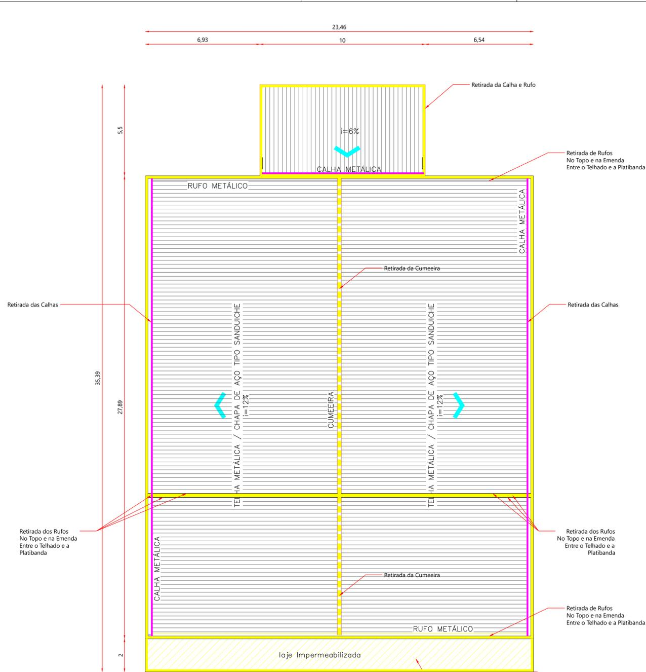
COBERTURA - DEMOLIÇÕES E RETIRADAS
